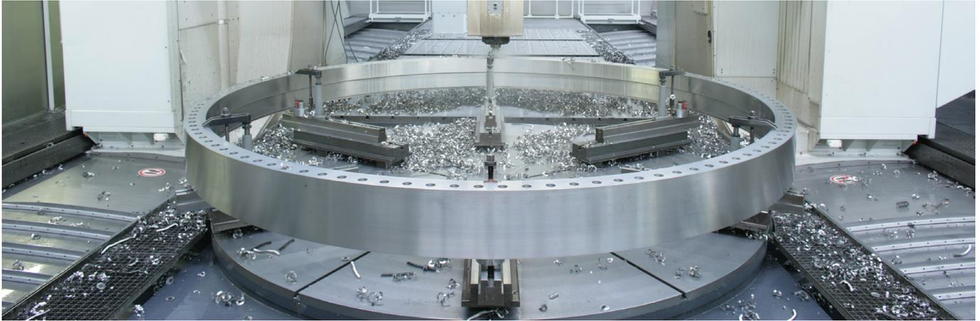
ausnahmslos Großkomponenten. Ein Teil mit einem Gewicht von 3 Tonnen gilt für uns als Kleinteil. Um ein Beispiel zu nennen: In Windkraftanlagen befinden sich große Ringe, die das Getriebe steuern. Solche Ringe, das sind unsere typischen Produkte.“
