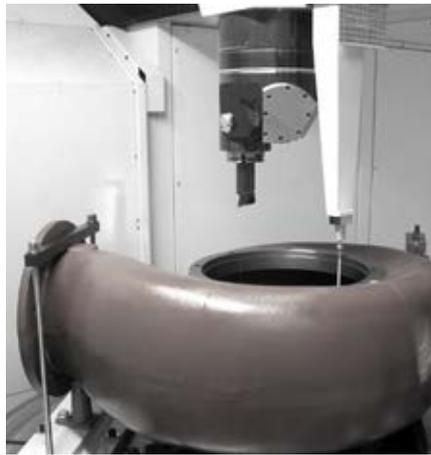
Damit kontrollieren Sie während des Bearbeitungsvorgangs die Abmessungen des Werkstücks. Das Besondere an diesen Messtaster: Sie fährt über einen separaten Schlitten am Stößel. So kann das verwendete Werkzeug einfach in der Spindel verbleiben. Sie sparen damit viel Zeit. Zudem ändert sich die Genauigkeit nicht, was dem Bearbeitungsergebnis zugutekommt. Für unsere UNIPORT-Portalfräsmaschinen bieten wir wahlweise einen separaten Messtaster an.
